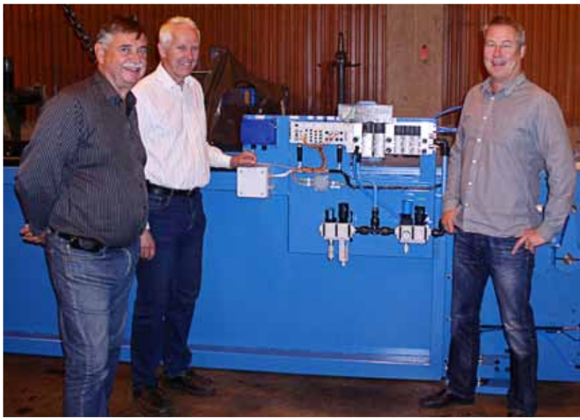
I sågverken finns ett antal enheter som ska positioneras, till exempel sågbanden. Balluffs linjärgivare skickar information om var sågbandet befinner sig och tar emot information om vart den ska. Lars Fröberg, elingenjör på Söderhamn Eriksson i Mariannelund och Rune Ingelsjö framför bandsågen.
